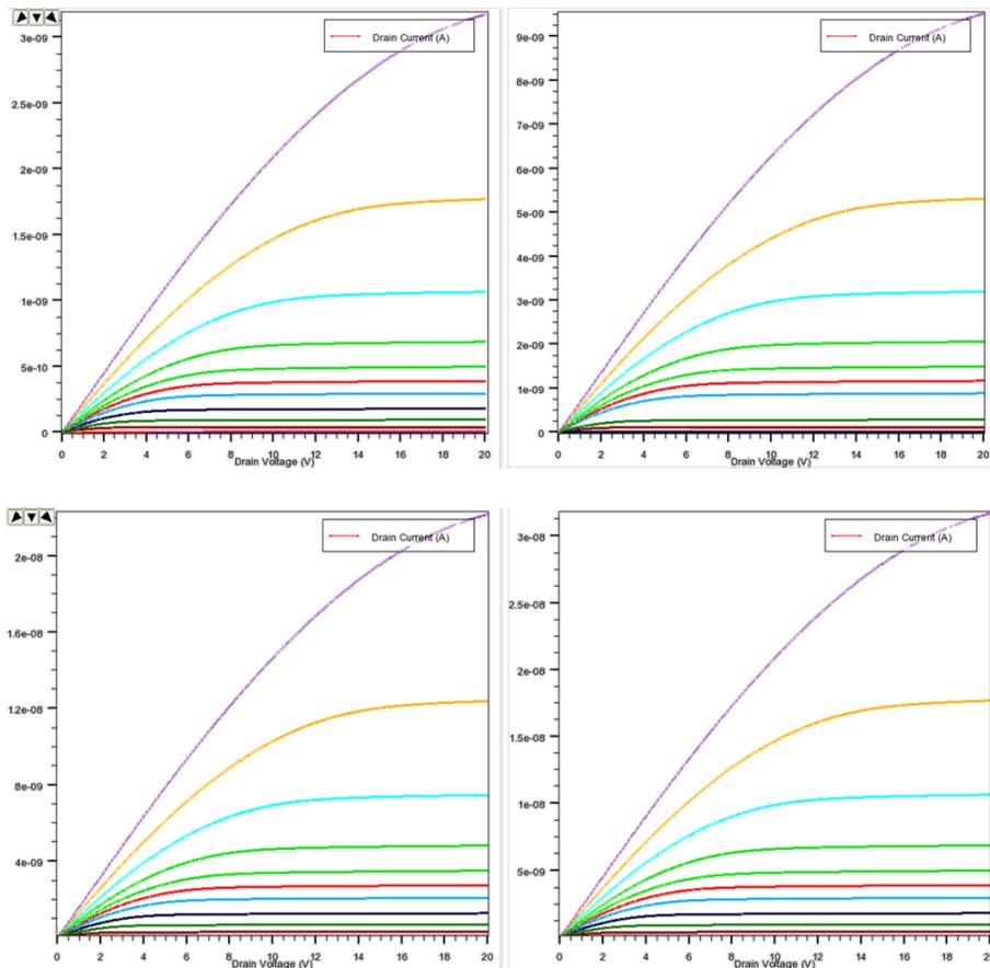
Fig. 8.1  $I_D$  versus  $V_{DS}$  for  $\mu_{n0} =$  (a) 0.1 (b) 0.3 (c) 0.7 (d) 1  $\text{cm}^2/\text{V}\cdot\text{sec}$
